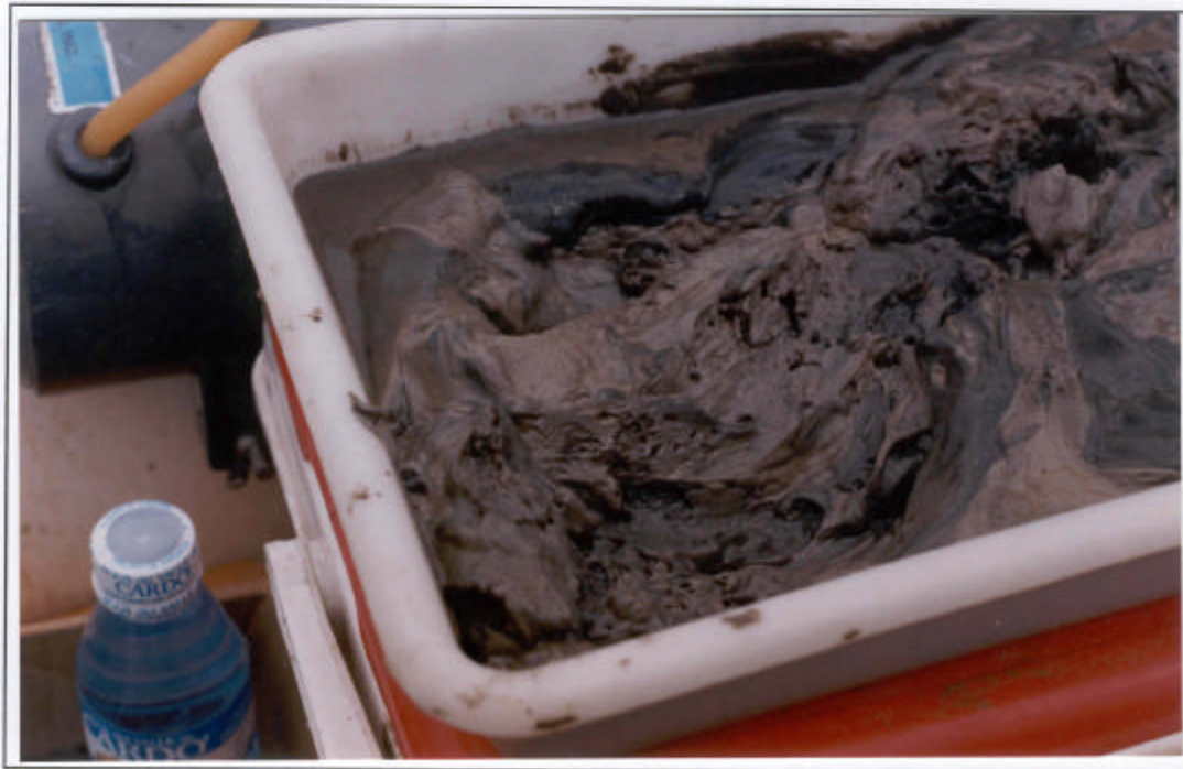
Detalle de la estructura del sedimento (cavidades) provocada por la presencia de gas metano.
