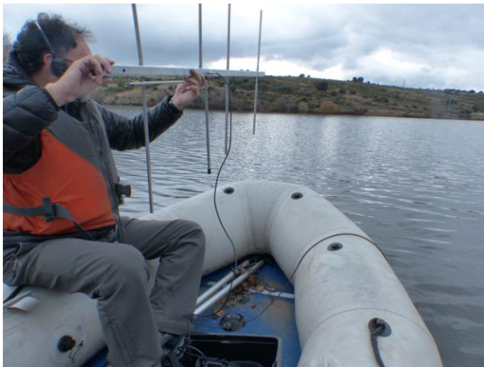
Seguimiento peces mediante radio marcaje
